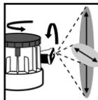
Variablen Sprühkopf auf Schadensgröße und Schadenslage einstellen.
