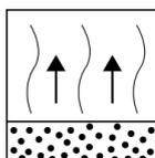
Zwischenablüft zwischen den Spritzgängen bis matt abgezogen = ca. 5 min.
