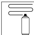
Trockenfilmschichtdicke 60 – 70 µm
