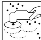
Für den Trockenschliff mit Maschine wird die Verwendung von Softscheiben mit Schaumrücken P 400 - P 800 oder Netzschliffscheiben empfohlen.
