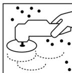
Ponçage à sec à la machine P 360 - P 500
