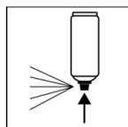
Después de pintar, voltear el bote y rociar hasta que la válvula quede libre de residuo.
