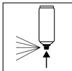
Après utilisation, retourner l'aérosol et purger la valve, pour éviter le grippage de la valve de pulvérisation.
