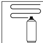
Das Produkt im Kreuzgang in mehreren Schichten aufsprühen.
